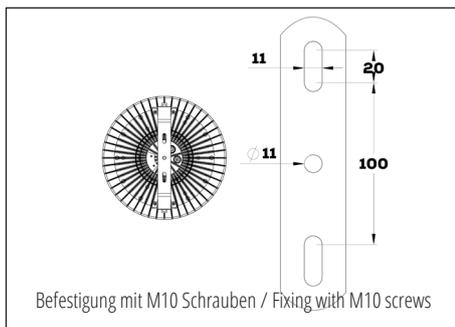
Befestigung mit M10 Schrauben / Fixing with M10 screws
