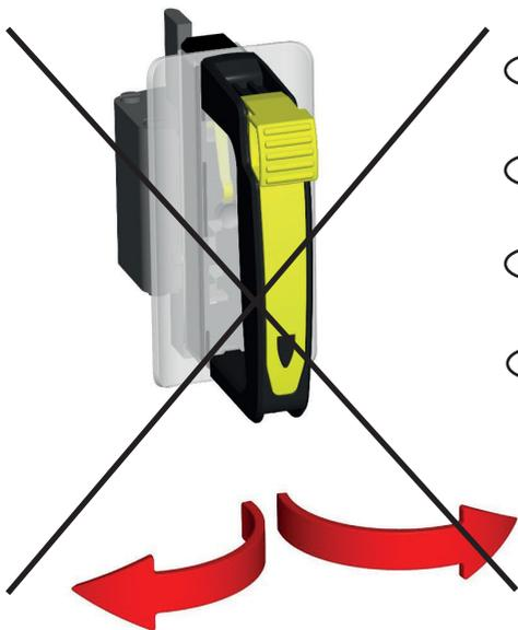
**D** Sicherungseinsatz nicht seitlich lockern oder ziehen!
