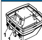
De waterpeilsensoren (1) regelmatig reinigen en onderzoeken op tekenen van beschadiging.
