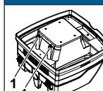
Senzory stavu vody (1) pravidelne čistite a skontrolujte ich na známky poškodenia.
