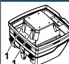
Vatteninnivåsensorema (1) ska rengöras regelbundet och undersökas efter tecken på skador.
