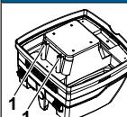
Rengør vandstandssensoren (1) regelmæssigt, og undersøg den for tegn på skader.
