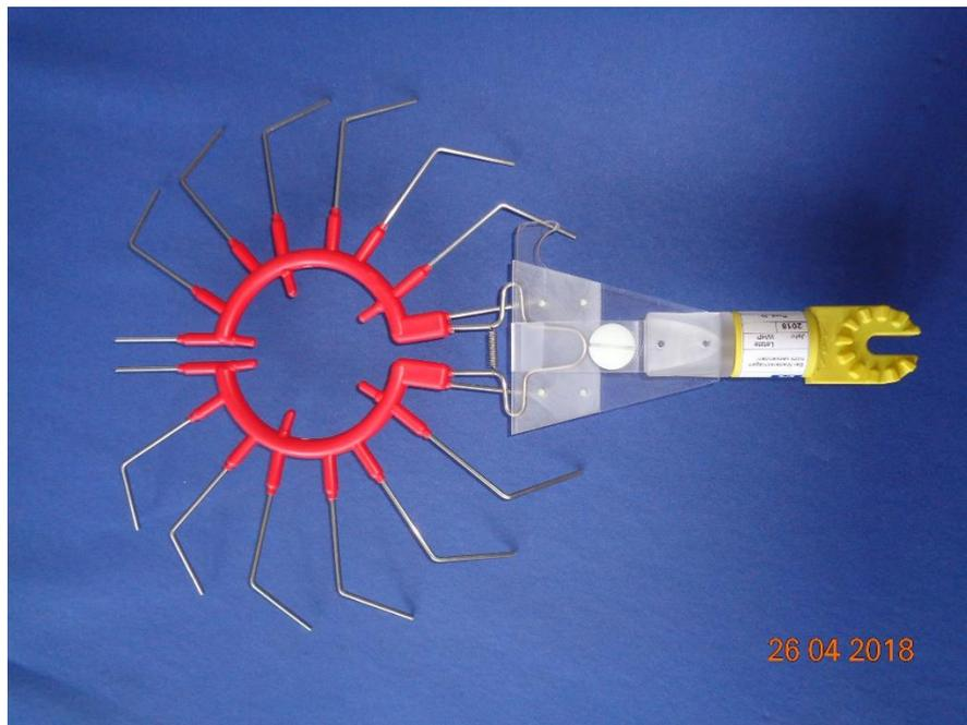
Mittels Rändelschraube auf dem Oberteil des Adapters kann die Klemmwirkung auf den Animal Guard verstärkt oder gelockert werden. Diese Klemmwirkung ist je nach den Anwendungsbedingungen auszuwählen. Dabei ist zu beachten, dass sich der Adapter mühelos vom Animal Guard abziehen lässt, nachdem er positioniert ist.
