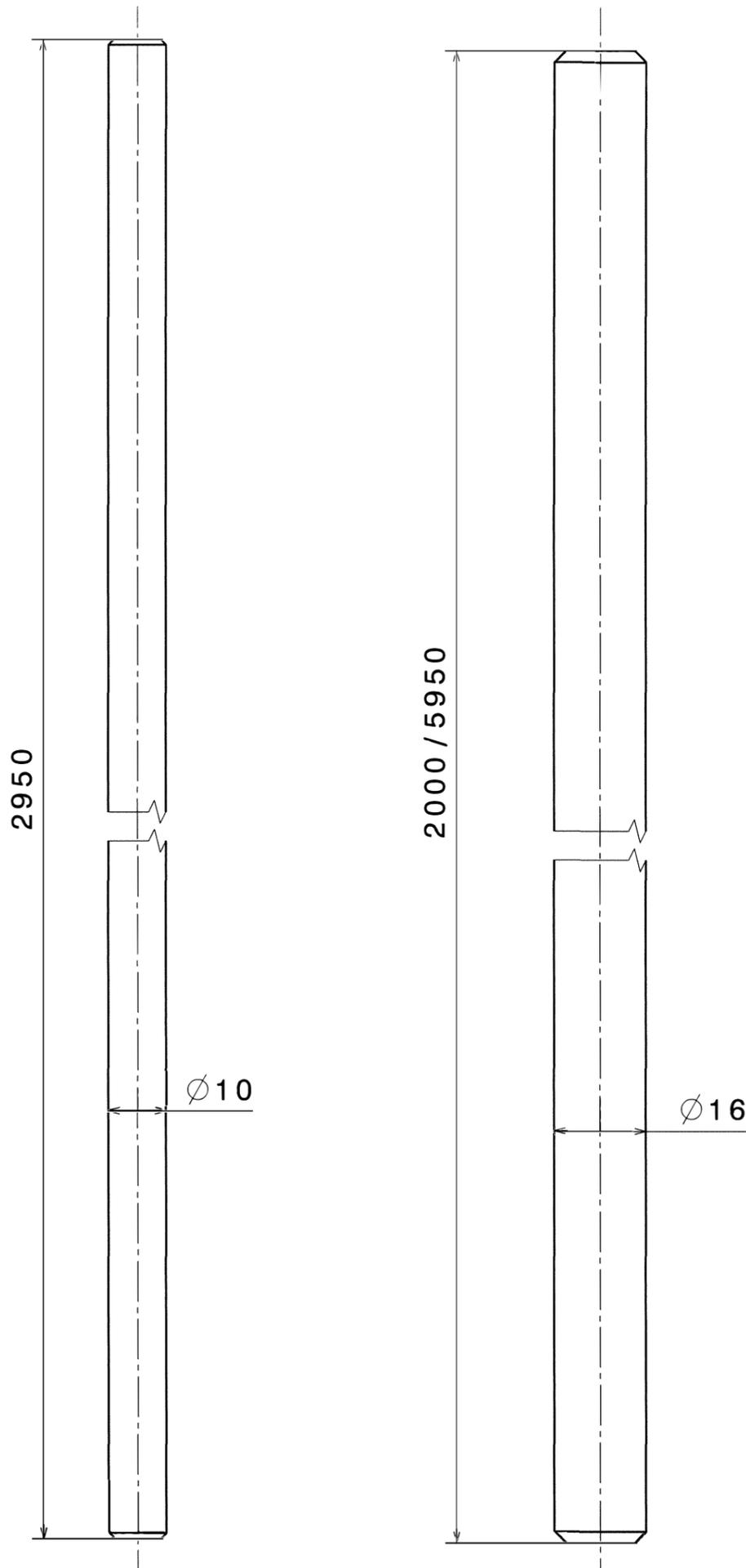
Alternativ können Runddrähte, St/tZn mit Durchmesser D=10mm und D=16mm in abweichenden Längen verwendet werden.
