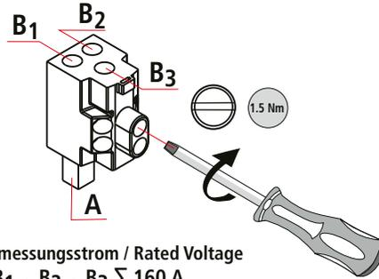
$I_L^{**})$  Bemessungsstrom / Rated Voltage
