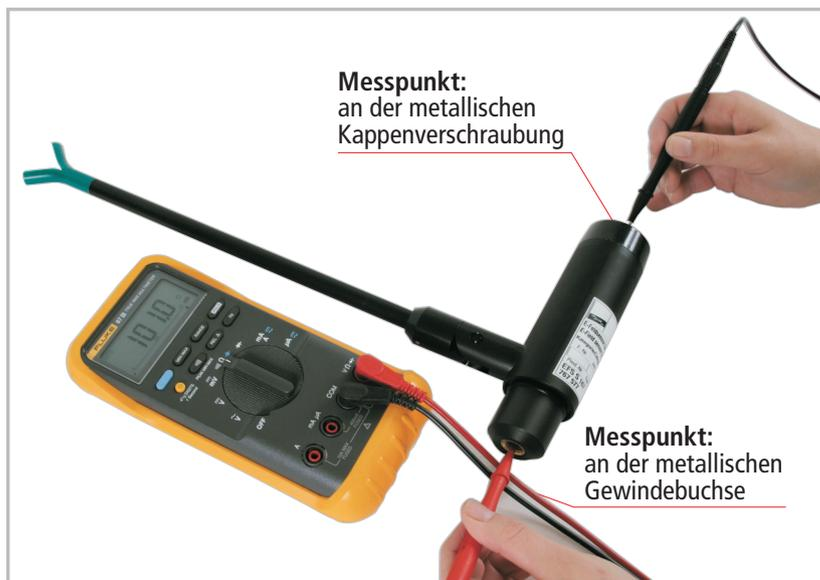
Bild 3.2.11 Funktionsprüfung am E-Feldsensor
