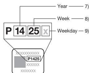
①) Elektronisches Vorschaltgerät für MH-Lampen; 2) Lampe; 3) Achtung! Vor Lampenwechsel von der Netzspannung trennen; 4) Testpunkt; 5) Drahtvorbereitung; 6) Hergestellt in China; 7) Jahr; 8) Woche; 9) Wochentag; 10) Universelles elektronisches Vorschaltgerät für MH-Lampen; 11) Zündzeitbegrenzung
