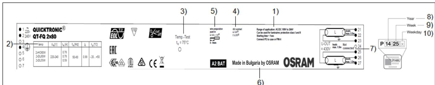
(D) 1) Anwendungsbereich: AC/DC 198V – 264V; Kann in Leuchten mit Schutzklasse I und II verwendet werden; Startzeit < 1sec; Verbinde PE mit Gehäuse oder PIN 4; 2) Lampe; 3) Temperatur Test; 4) IDC Kontakt; 5) Drahtvorbereitung; 6) Hergestellt in Bulgarien von OSRAM; 7) Nicht verbunden; 8) Jahr; 9) Woche; 10) Wochentag (optional);
