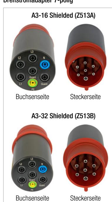
Die Drehstromadapter A3-16 Shielded und A3-32 Shielded dienen dem problemlosen Anschließen von Prüfgeräten an 7-polige CEE-Steckdosen. Die zwei Ausführungen unterscheiden sich durch die Größe des Steckers, der jeweils den 7-poligen CEE-Steckdosen mit den Nennströmen 16 A und 32 A entspricht.
