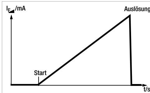
In der Schalterstellung  $I_F$  fließt ein langsam ansteigender Gleichstrom über N und PE. Der aktuelle Strommesswert wird hierbei ständig angezeigt. Bei Auslösung des RCD-Schalters
