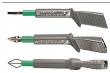
Drei selbsthaltende Prüfspitzen mit Berührungsenschutz zum Anschluss von Messleitungen mit 4 mm-Bananensteckern bzw. mit berührungsgeschützten Steckern an Buchsen mit Öffnungen von 3,5 mm bis 12 mm, z. B. CEE-, Perilex-Steckdosen usw.
