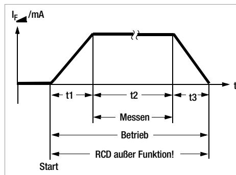
Der RCD-Schalter kann diesen Messstrom dann nicht mehr erkennen und löst folglich während der Messung nicht mehr aus.
