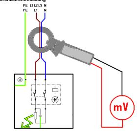
Direkte Messmethode (Messung des Schutzleiterstroms)
