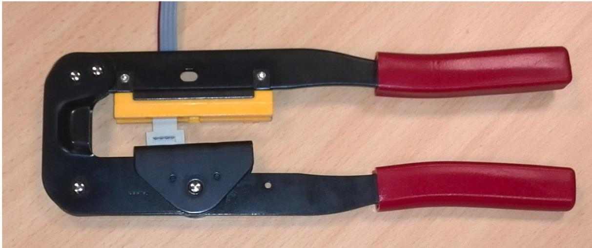
Die Stecker werden mit einer geeigneten Zange auf das Kabel gequetscht.
