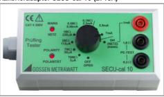
Der Kalibrieradapter ist zum Überprüfen von Prüfgeräten nach DIN VDE 0701-0702/IEC 62353 (VDE 0751) auf deren Messunsicherheit hin bestimmt. Gemäß den Vorgaben der Unfallverhütungsvorschrift DGUV Vorschrift 3 (bisher BGV A3) und bei einer Zertifizierung nach dem Qualitätsstandard ISO 9000 sind diese Prüfgeräte in der Regel einmal jährlich zu überprüfen.
