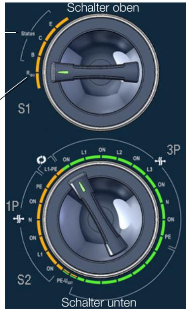
Schalterstellungen orange: Messungen/Prüfungen an 1-phasigen Mode 2/3-Kabeln
