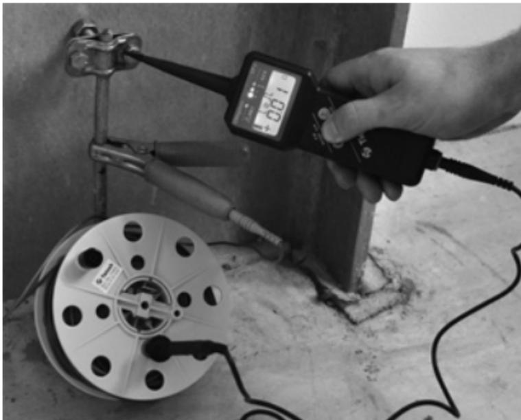
Das Gerät muss für den Abgleich ausgeschaltet sein.
