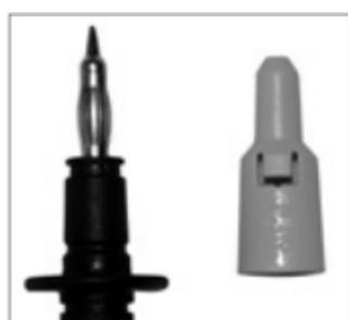
Nur mit der auf der Prüfspitze der Messleitung aufgesteckten Sicherheitskappe dürfen Sie nach DIN EN 61010-031 in einer Umgebung nach Messkategorie III messen.
