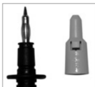
Vous ne devez prendre de mesure selon DIN EN 61010-031 dans un environnement selon la catégorie de mesure III qu'avec le capuchon de sécurité inséré sur la pointe de touche du cordon de mesure.
