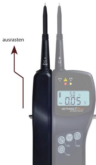
Für Prüfungen an Schukosteckdosen kann der Griff am Anzeigeteil eingerastet bleiben, bei anderen Prüfungen sowie dem Eigentest muss dieser getrennt werden.
