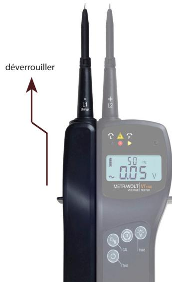
Pour les tests sur les prises de sécurité (Schuko), la poignée de l'afficheur peut rester verrouillée. Elle doit en revanche être séparée pour les autres tests ainsi que le test interne.
