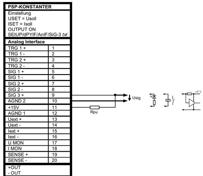
Bild 7.3 Beschaltungsbeispiele der Statussignal-Ausgänge
