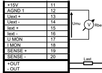
Bild 7.6 Verdrahtung Spannungsmonitor.
