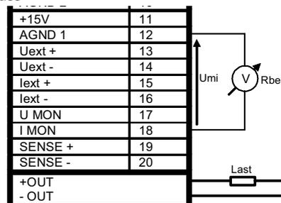
Bild 7.7 Verdrahtung Strommonitor.
