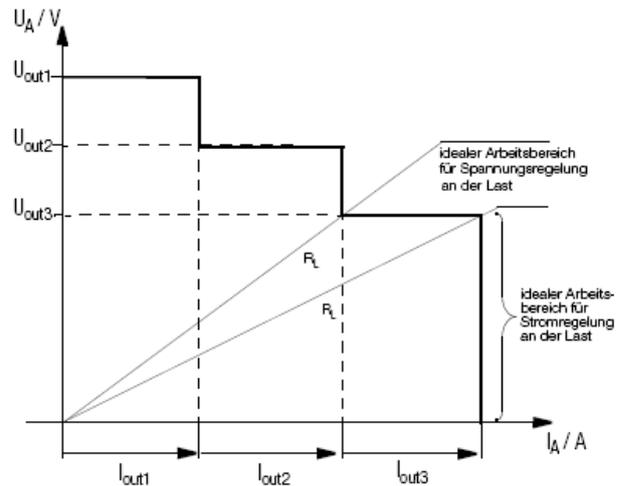
Bild 7.9.1b U / I Diagramm bei direkter Parallelschaltung
