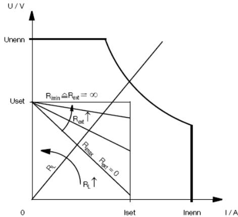
Bild 7.11a Abhängigkeit der Ausgangsspannung von der Belastung
