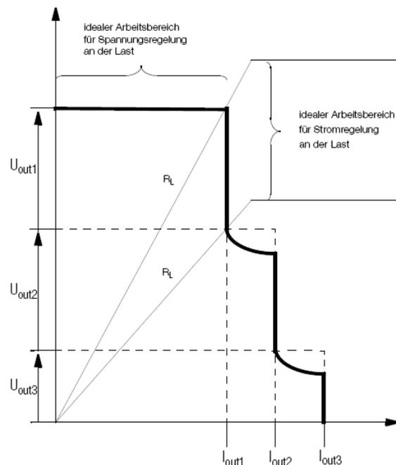
Bild 7.10.1b U / I Diagramm bei direkter Serienschaltung
