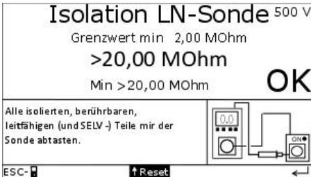
Bei dieser Messung wird L und N im Prüfgerät kurzgeschlossen und eine Prüfspannung von 500 V (bei „Überspannungsableiter: Ja“ mit 250 V) zwischen LN und PE angelegt.
