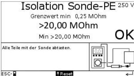
Isolationswiderstandsmessung Sonde gegen leitfähige Teile (die mit PE verbunden sind).
