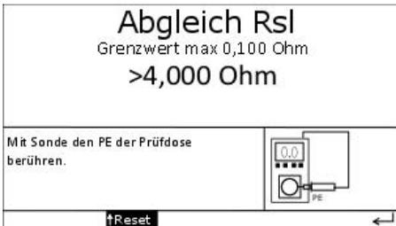
Dieses Menü ermöglicht den Abgleich des Widerstandswerts der Sondenleitung. Der maximale Offsetwert, der hierzu von künftigen Messwerten abgezogen wird, darf max. 0,100  $\Omega$  betragen.
