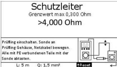
Bei Anschluss des Prüflings wird der Widerstand zwischen Schutzleiteranschluss an der Prüfdose und dem Sondenanschluss am Prüfling (Berührung leitfähiger Teile des Gehäuses) gemessen.
