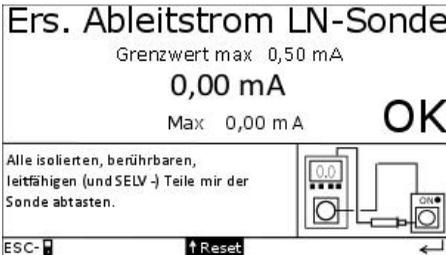
Die Messung wird im spannungslosen Zustand des Prüflings durchgeführt.
