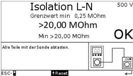
Diese Messung dient zur Überprüfung der Isolation von z. B. Verlängerungsleitungen und Mehrfachsteckdosen (über optionale Adapter) ohne Beschaltung (z. B. Glühlampen).
