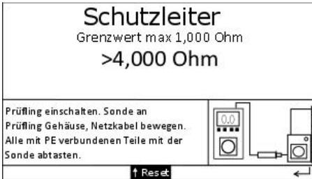
Bei fest angeschlossenen Geräten: versorgen Sie das Prüfgerät – wenn möglich – im Stromkreis des Prüflings mit Spannung.
