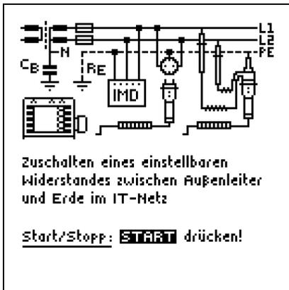
Berücksichtigen Sie bei der Einstellung des Prüf Widerstands, dass ein zu hoher Prüfstrom empfindliche Anlagenteile beschädigen kann.
