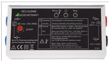
Der Prüfadapter dient in Verbindung mit dem Prüfgerät zum Prüfen von Schweißgeräten nach der Norm IEC 60974-4 / EN 60974-4 / VDE 0544-4. Hiernach dürfen die Scheitelwerte der Leerlaufspannung bei allen möglichen Einstellungen die Grenzwerte nicht überschreiten.
