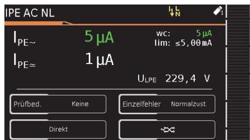
Prüfsequenz – Prüfergebnis (EN 50699 / VDE 0702)
