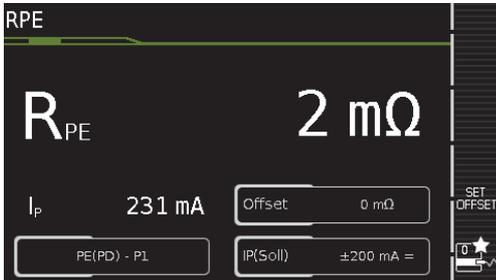
Prüfsequenz – Start (EN 50678 / VDE 0701)
