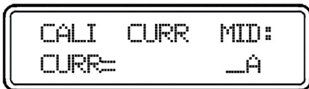
Geben Sie die Ablesewerte vom Multimeter ein (vier Dezimalstellen). Mit "Clear" können Sie fehlerhafte Eingaben korrigieren. Bestätigen Sie mit "Enter".
