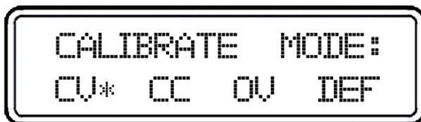
Wählen Sie eine der Optionen CV, CC oder OV. Mit der Auswahl "DEF" setzen Sie alle Parameter auf die Werkseinstellungen zurück. Die Betriebsarten CV, CC und OV sollten nacheinander in exakt dieser Abfolge kalibriert werden. Öffnen Sie nach Abschluss der Kalibrierung einer Betriebsart wieder das Kalibrier-Menü. Drücken Sie "Clear" zum Verlassen des Kalibriermodus.
