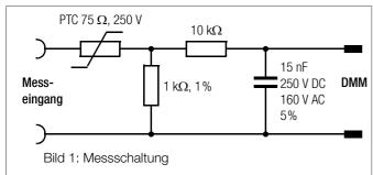
Bedingt durch die Bauform verfügt dieser Adapter nicht über eine Schmelzsicherung. Der Überlastschutz wird durch ein PTC-Element realisiert, welches bei niedriger Impedanz des Prüfpunktes den fließenden Ableitstrom zusätzlich verringert. Die Impedanz des Prüflings sollte größer als 30 k $\Omega$  sein. Bei Ansprechen des Überlastschutzes stellt sich dieser nach Trennen vom Eingangskreis selbsttätig zurück. Lassen Sie hierzu den Adapter 1 bis 2 Minuten stromlos abkühlen.
