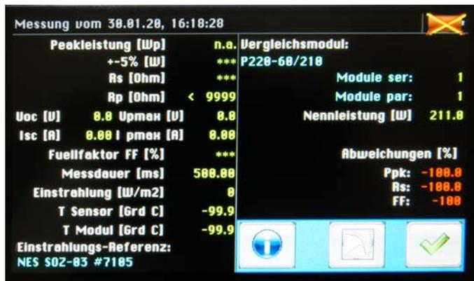
Auf der Ergebnis-Seite werden die berechneten (Peakleistung,  $R_s$ ,  $R_p$ , FF) und gemessenen Daten (Spannungen und Ströme) angezeigt.
