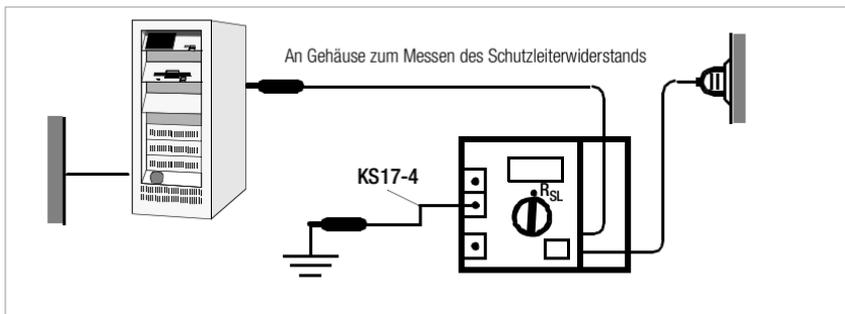
Bei Datenverarbeitungssystemen oder Kombinationen mit fest angeschlossenen Einzelgeräten sollen der Verbund gelöst und Einzelmessungen durchgeführt werden. Wenn diese Auftrennung nicht zweckmäßig ist, dürfen die Einzelmessungen an den untereinander verbundenen Geräten durchgeführt werden.
