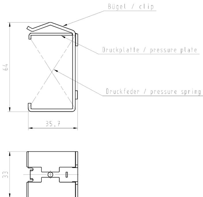
montierter Zustand/mounted state
