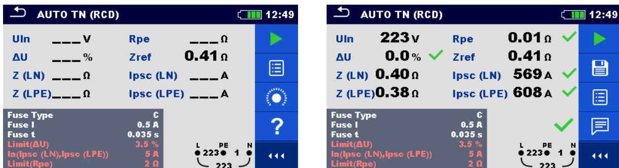
Abbildung 7.77: Beispiele für Ergebnisse der AUTO TN (RCD)-Messung
