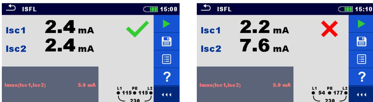
Abbildung 7.65: Beispiele für Ergebnisse des Erstfehler-Ableitstroms
