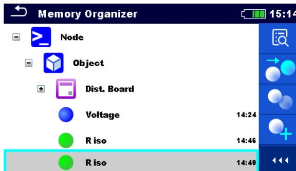
Die wiederholte Prüfung ist unter dem gleichen Strukturelement wie die ursprüngliche Messung gespeichert.
