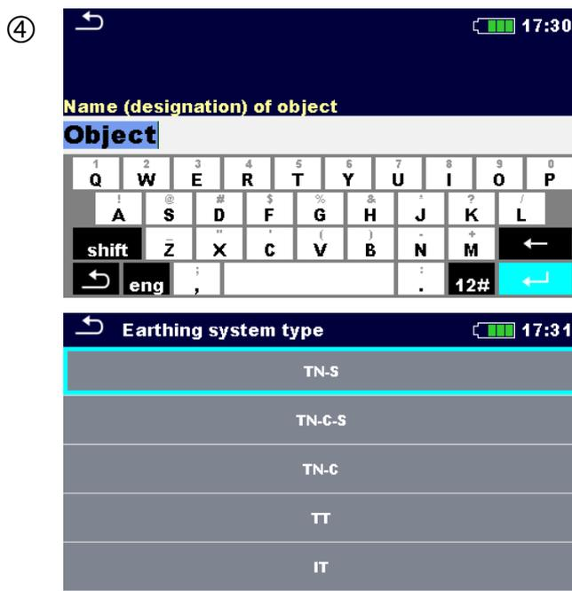
Im Parameter-Menü können Parameter von einer Drop-Down-Liste ausgewählt, oder mit der Tastatur eingegeben werden. Für weitere Informationen zur Tastaturbedienung siehe Kapitel 4 **Bedienung des Prüfgeräts**.
