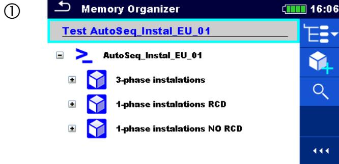
Die Kopfzeile des aktiven Auftrags ist ausgewählt und die Suchfunktion ist verfügbar.
