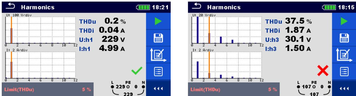
**Abbildung 7.58: Beispiele für Ergebnisse der Oberwellenmessung**
