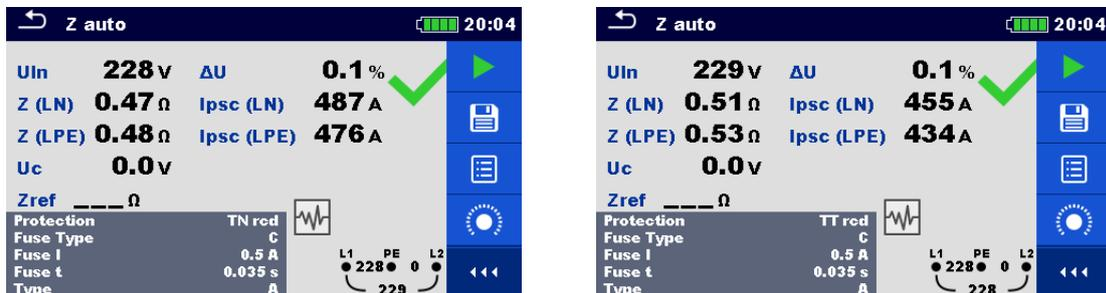
Abbildung 7.45: Beispiele für Ergebnisse der Z Auto Messung
