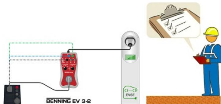
Abbildung 7.85: Funktionsprüfung
