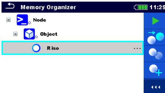
Eine neue leere Messung wird unter dem ausgewählten Strukturelement hinzugefügt.
