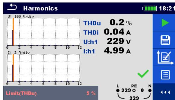
Abbildung 6.5: Beispiel für ein Ergebnis der Oberwellenmessung
