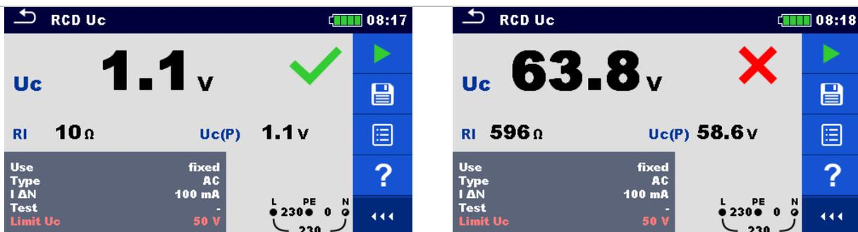
**Abbildung 7.26 Beispiele für die Ergebnisse der Berührungsspannungsmessung**
