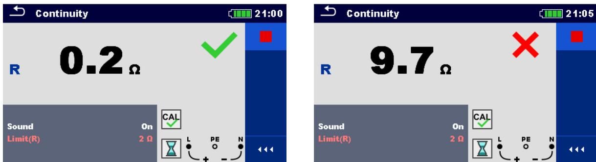
**Abbildung 7.21: Beispiele für Ergebnisse der kontinuierlichen Durchgangsprüfung**
