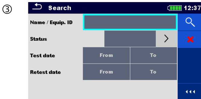
Die Suchparameter werden angezeigt. Der Name / Geräte-ID bezieht sich auf die Bezeichnung aller Strukturelemente.
