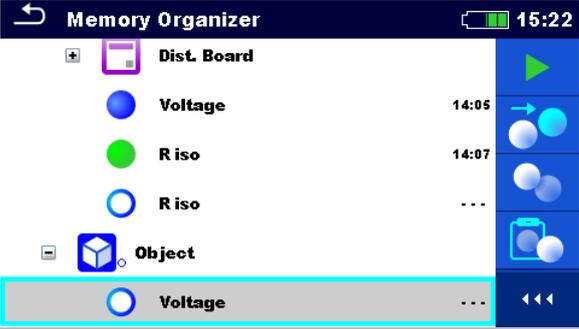
Die neue (leere) Messung wird im ausgewählten Strukturelement angezeigt.
