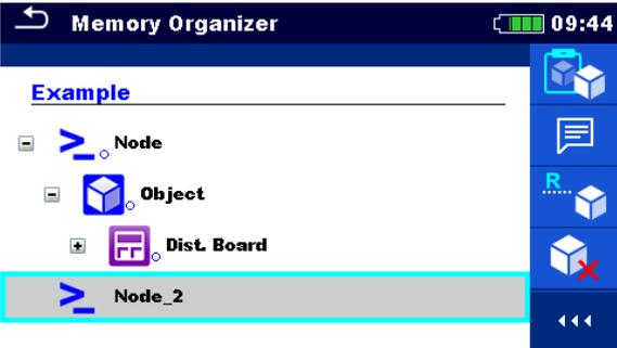
Wählen Sie einen neuen Ort, an dem das Strukturelement (mit Unterstrukturen und Messungen) verschoben werden soll.
