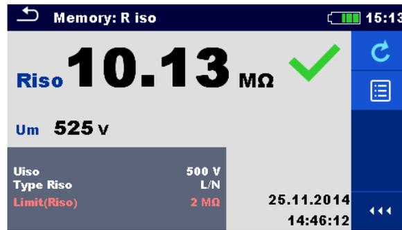
Abbildung 6.12: Speicherbildschirm einer Messung, Beispiel für Isolationswiderstandsmessung
