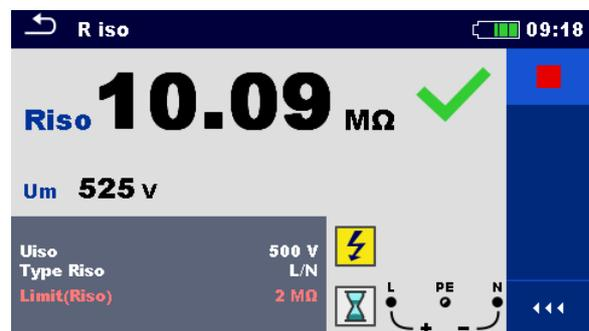
**Abbildung 6.1: Bildschirmanzeige einer Einzelprüfung, Beispiel für Isolationswiderstandsmessung**
