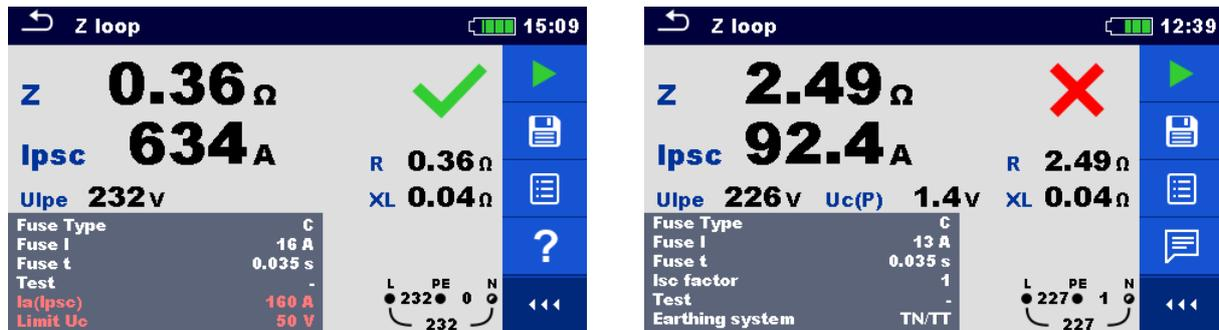
Abbildung 7.32: Beispiele für Ergebnisse der Schleifenimpedanzmessung
