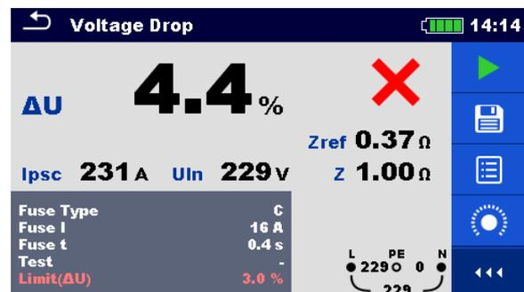
Abbildung 7.42: Beispiele für Ergebnisse der Spannungsfallmessung (Schritt 2)
