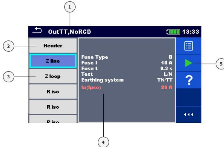
**Abbildung 8.4: Ansichts-Menü der Auto Sequence® – Einzelprüfung ausgewählt**
