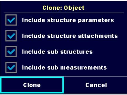
Das Menü zum Klonen eines Strukturelements wird angezeigt. Unterelemente und Parameter des ausgewählten Strukturelements können angewählt oder abgewählt werden.
