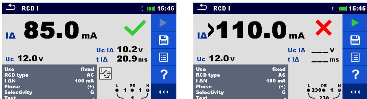
Abbildung 7.28: Beispiele für die Ergebnisse des Auslösestroms
