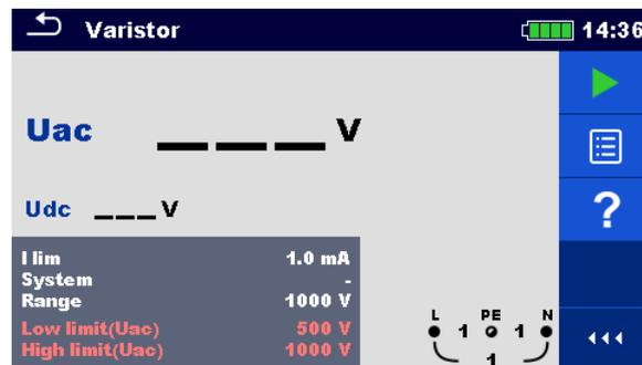
Abbildung 7.13: Hauptmenü Varistorprüfung
