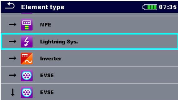
Wählen Sie aus der Liste der verfügbaren Strukturelemente den gewünschten Elementtyp aus. Die Pfeile vor dem Element bestimmen die Position innerhalb der vorhandenen Struktur.
