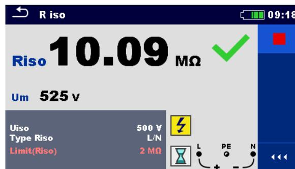
Abbildung 6.3: Einzelprüfung wird ausgeführt, Beispiel für Isolationswiderstandsmessung
