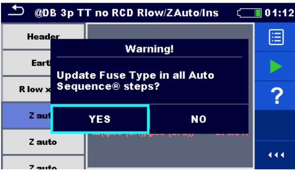
Der Prüfer muss entscheiden, ob die Änderungen der globalen Parameter für alle Einzelprüfungen, die die geänderten Parameter enthalten, innerhalb der ausgewählten Auto Sequence® gelten oder nur für die geänderte Einzelprüfung.
