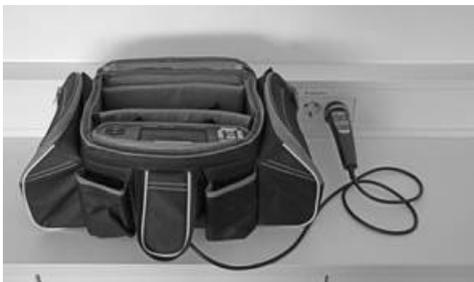
Das Prüfgerät kann auch in der gepolsterten Tasche getragen und liegend verwendet werden. Die Tragetasche besitzt eine Öffnung zur Durchführung der Prüfleitung.
