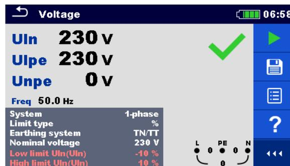
**Abbildung 7.4: Beispiel für die Spannungsmessung in einem Einphasensystem**
