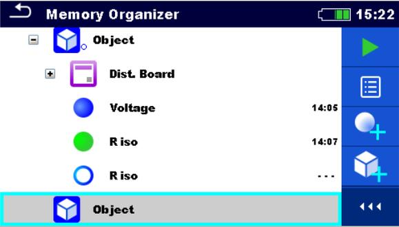
Wählen Sie die Position, an der die Messung eingefügt werden soll.
