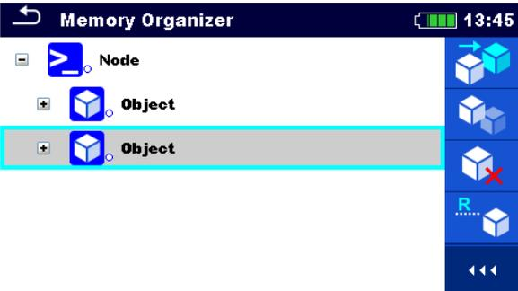
Das geklonte Strukturelement wird auf derselben Ebene eingefügt.
