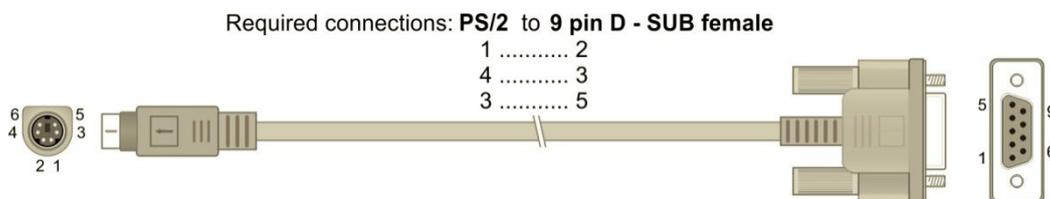
**Abbildung 9.1: Optionales RS 232-PS/2 Schnittstellenkabel (10008313) für die Datenübertragung**
