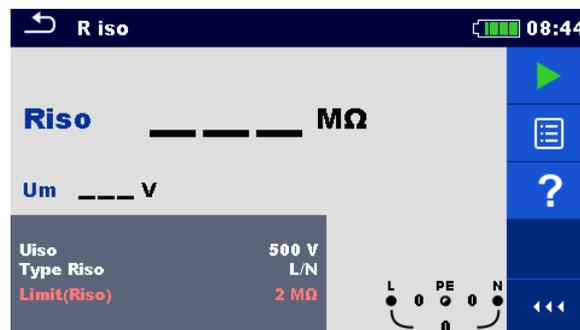
**Abbildung 6.2: Startbildschirm einer Einzelprüfung, Beispiel für Isolationswiderstandsmessung**
