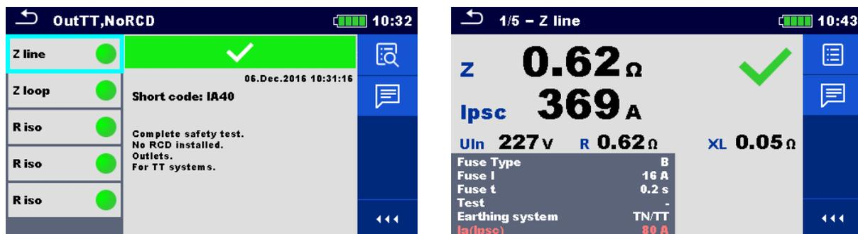
Abbildung 8.8: Ergebnisanzeige einer Einzelprüfung der Auto Sequence®
