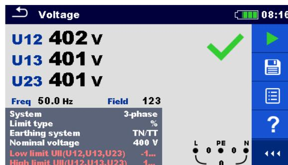
**Abbildung 7.5: Beispiel für die Spannungsmessung im Dreiphasensystem**
