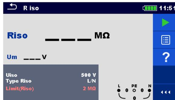
Abbildung 7.6: Menü Isolationswiderstandsmessung
