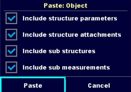
Das Menü zum Einfügen eines Strukturelements wird angezeigt. Unterelemente und Parameter des ausgewählten Strukturelements können angewählt oder abgewählt werden.
