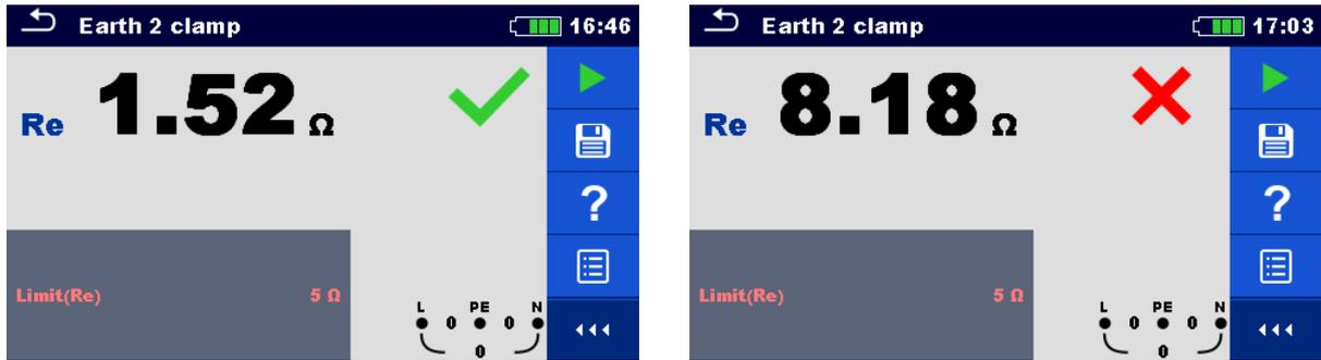
**Abbildung 7.52: Beispiele für Ergebnisse der Erdungsmessung mit 2 Stromzangen**
