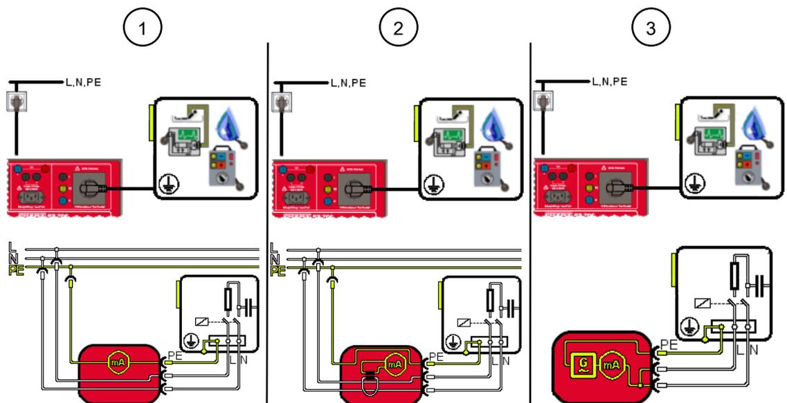
Abb. 16: Schutzleiterstrom prüfen (Anschlussschema, Stromlaufplan)
