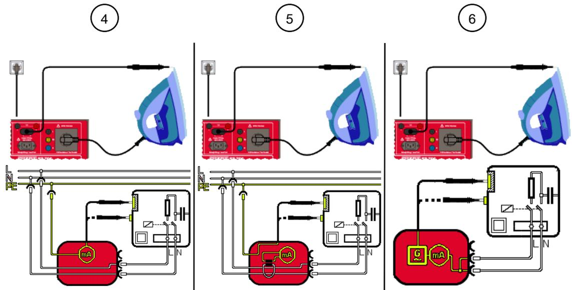
Abb. 18: Berührungsstrom prüfen SK II (Anschlusschema beispielhaft für VDE 0701 und VDE 0702, Stromlaufplan)
