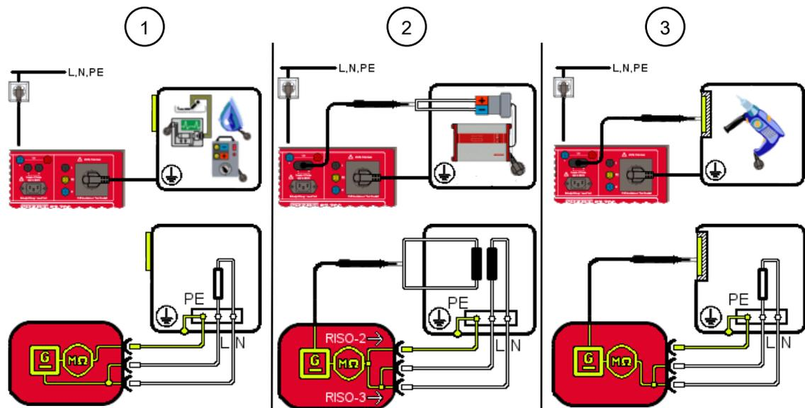
Abb. 13: Isolationswiderstand prüfen SK I (Anschlussschema beispielhaft für VDE 0701 und VDE 0702, Stromlaufplan)
