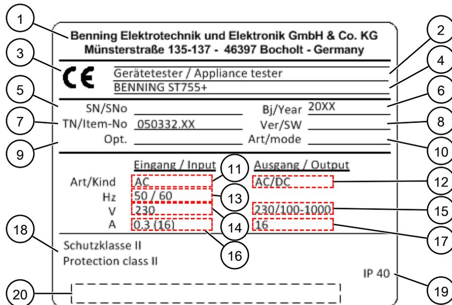
Abb. 2: Typenschild (beispielhaft)
