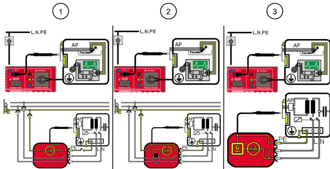
Abb. 19: Geräteableitstrom prüfen (Anschlussschema für VDE 0751-1, Stromlaufplan)
