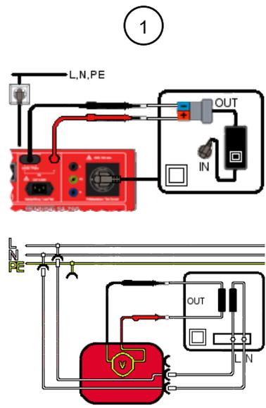
Abb. 24: Schutzkleinspannung prüfen SK I (Anschlussschema, Stromlaufplan)
