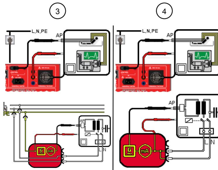
Abb. 21: Patientenableitstrom prüfen SK II (Anschlussschema für VDE 0751-1, Stromlaufplan, AP-Typ F)
