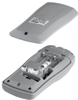
Bild 13: Sicherungswchsel Fig. 13: Fuse replacement Rys. 13: Wymiana bezpiecznika
