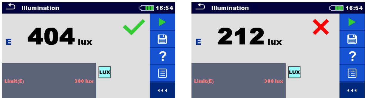
Abbildung 4.71: Beispiele für Ergebnisse der Beleuchtungsstärkemessung
