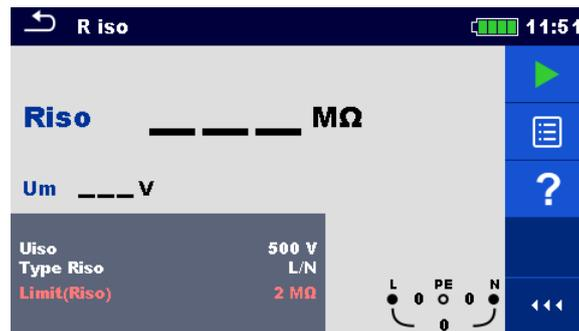
Abbildung 4.6: Menü Isolationswiderstandsmessung
