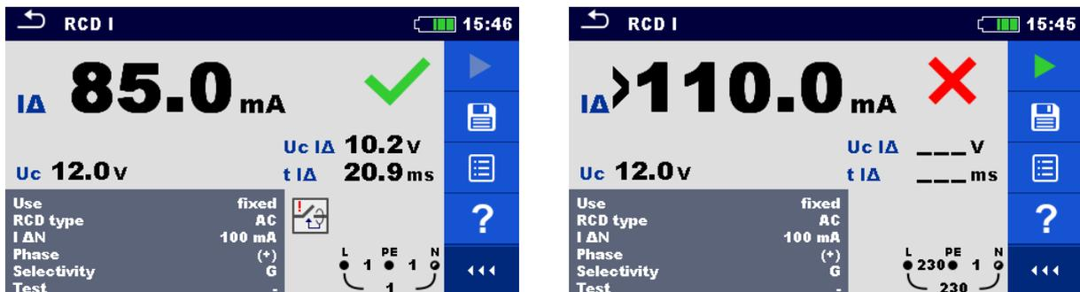
Abbildung 4.28: Beispiele für die Ergebnisse des Auslösestroms
