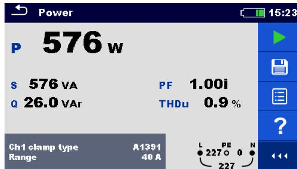
Abbildung 4.55: Beispiel für das Ergebnis der Leistungsmessung
