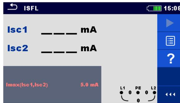
Abbildung 4.62: Menü ISFL – Erstfehler-Ableitstrom
