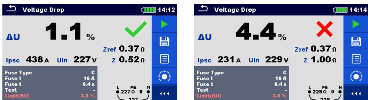
Abbildung 4.42: Beispiele für Ergebnisse der Spannungsfallmessung (Schritt 2)
