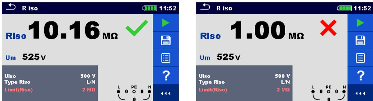
Abbildung 4.8: Beispiele für Ergebnisse der Isolationswiderstandsmessung
