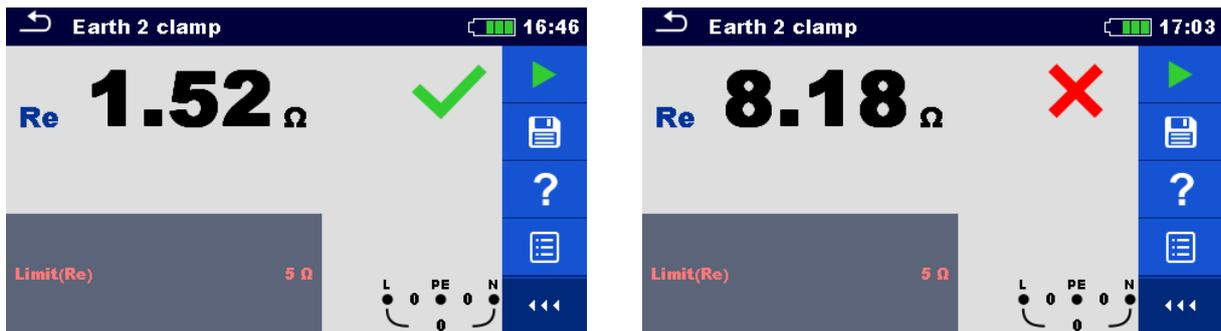
Abbildung 4.52: Beispiele für Ergebnisse der Erdungsmessung mit 2 Stromzangen
