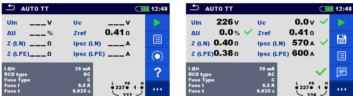
Abbildung 4.74: Beispiele für Ergebnisse der AUTO TT-Messung
