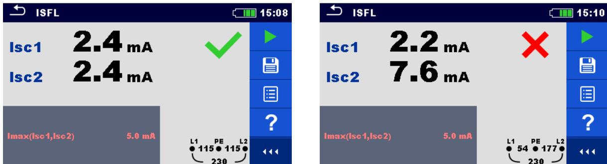
Abbildung 4.65: Beispiele für Ergebnisse des Erstfehler-Ableitstroms
