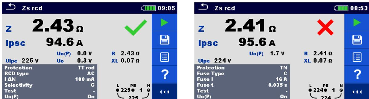
Abbildung 4.35: Beispiele für Ergebnisse der Zs RCD Messung
