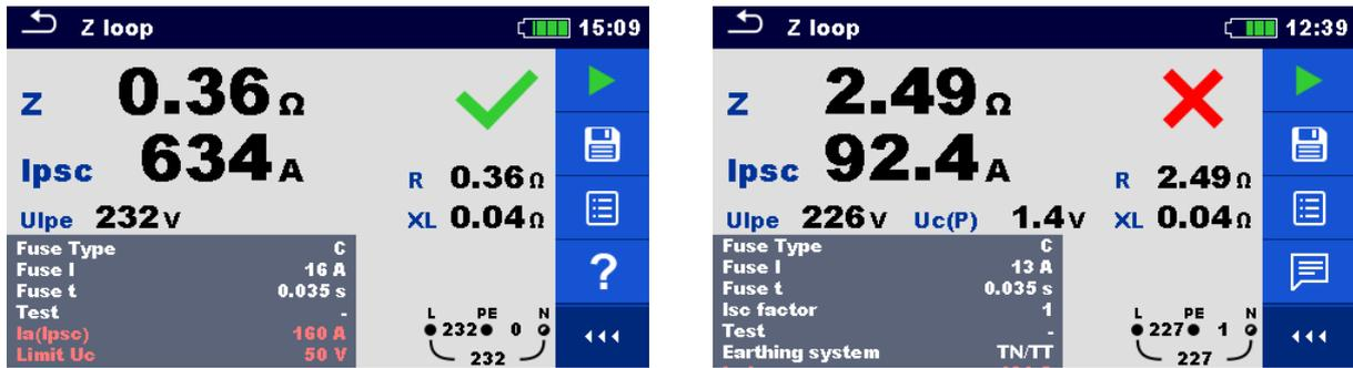
**Abbildung 4.32: Beispiele für Ergebnisse der Schleifenimpedanzmessung**
