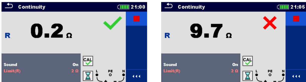
Abbildung 4.21: Beispiele für Ergebnisse der kontinuierlichen Durchgangsprüfung
