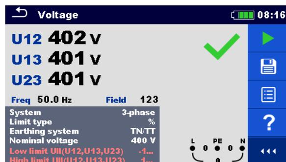
Abbildung 4.5: Beispiel für die Spannungsmessung im Dreiphasensystem
