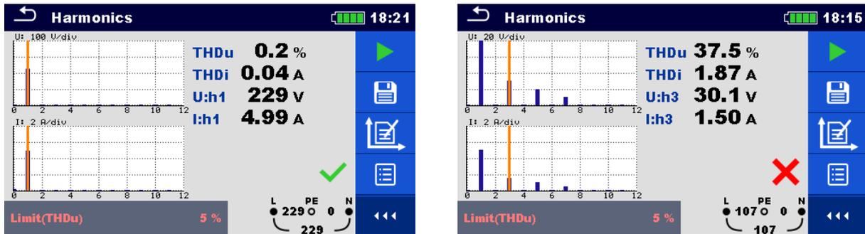
Abbildung 4.58: Beispiele für Ergebnisse der Oberwellenmessung
