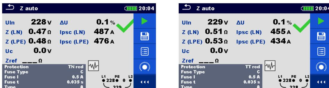
Abbildung 4.45: Beispiele für Ergebnisse der Z Auto Messung
