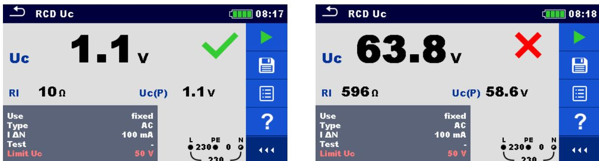
**Abbildung 4.26 Beispiele für die Ergebnisse der Berührungsspannungsmessung**
