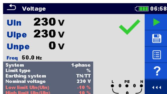
Abbildung 4.4: Beispiel für die Spannungsmessung in einem Einphasensystem
