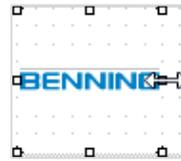
Ziehen Sie den markierten Positionsrahmen in die gewünschte Größe. Nutzen Sie dazu die Greifpunkte des Positionsrahmens.
