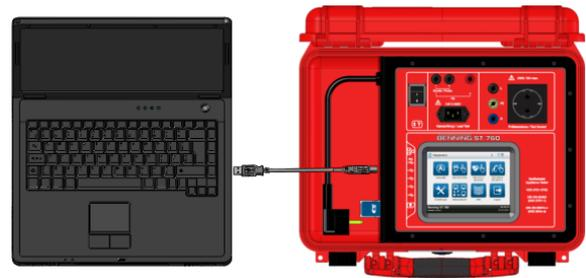
Nach dem Anschluss des Gerätetesters erkennt der PC den Gerätetester als Wechseldatenträger und ermöglicht den Zugriff auf die eingesteckte SD-Karte.
