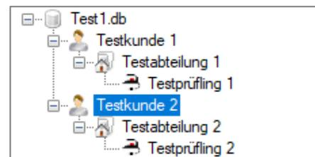
Kundeneinträge und Geräte-IDs aus der **Arbeitsdatenbank** werden beim *Zusammenführen* mit den Kundeneinträgen und Geräte-IDs der **Stammdatenbank** abgeglichen. Identische Einträge werden vom Importvorgang ausgeschlossen.
