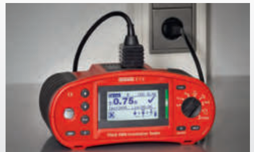
IT 115 bei der Schleifenimpedanzmessung ohne RCD-Auslösung
