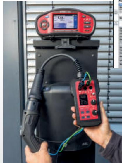
Messadapter EV 3-3 in Kombination mit dem Installationsprüfgerät IT 200 (044106) (optional)
