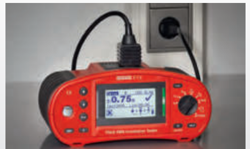
IT 115 bei der Schleifenimpedanzmessung ohne RCD-Auslösung
