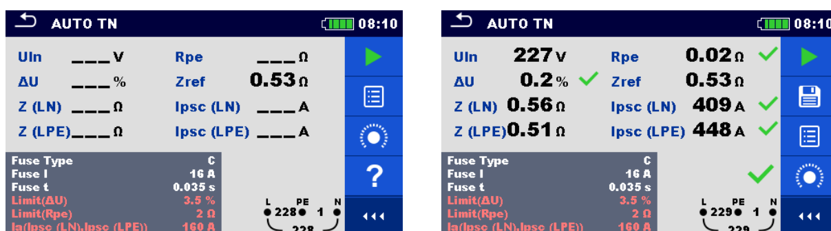
Abbildung 4.80: Beispiele für Ergebnisse der AUTO TN-Messung
