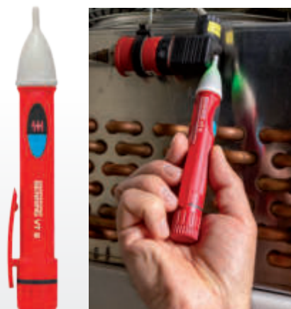
CAT IV 600 V Prüfung eines Magnetventils
