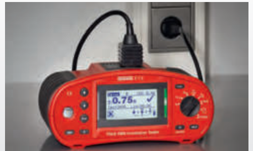
IT 115 bei der Schleifenimpedanzmessung ohne RCD-Auslösung
