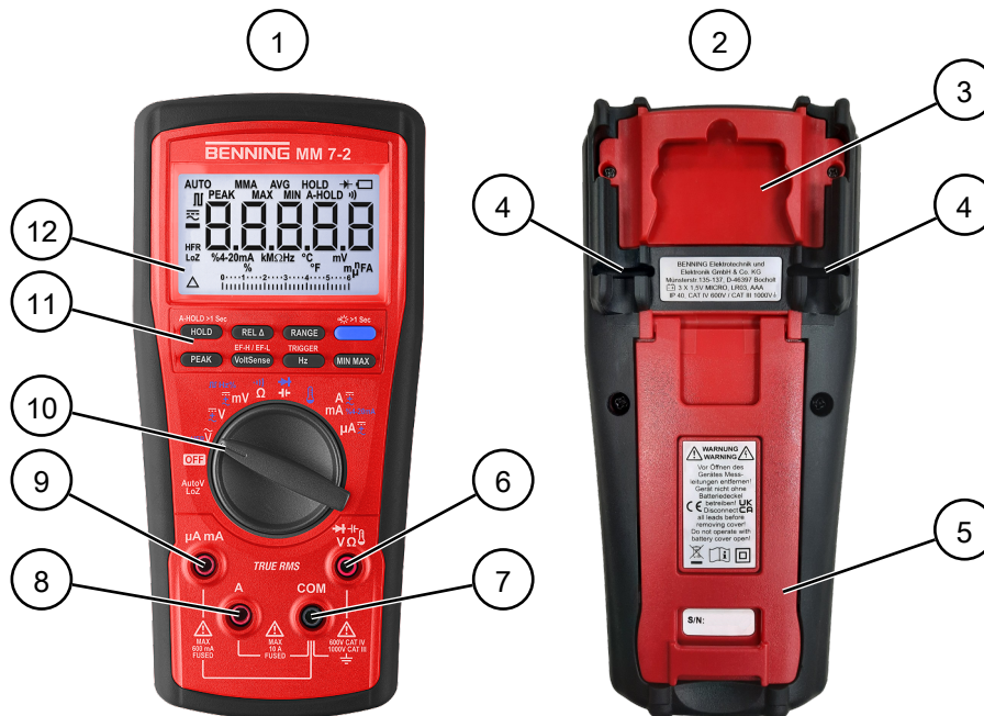
Illustration 6: Structure de l'appareil BENNING MM 7-2
