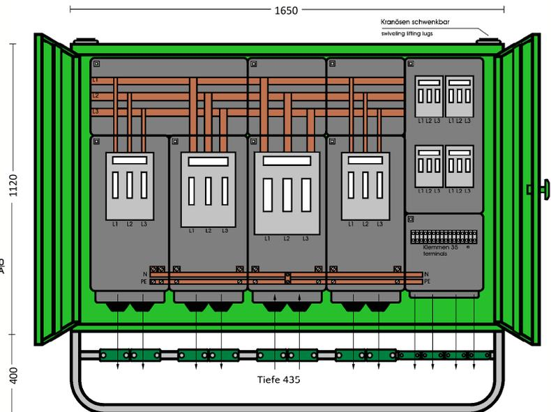
**ELEKTRA** - Gruppenverteilerschrank im Gehäuse aus verzinktem Stahlblech, pulverbeschichtet RAL 6018, bestückt mit:
