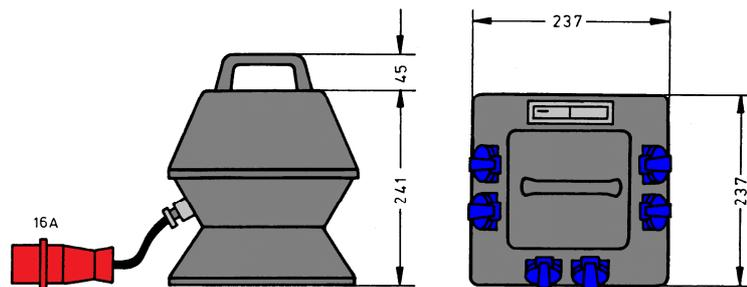
**ELEKTRA** – Steckdosenverteiler im Vollgummigehäuse mit Tragegriff,
