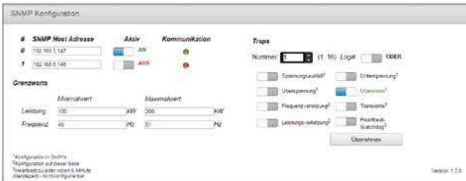
Abb.: Konfigurationsseite auf einem UMG ohne RCM-Funktionalität
