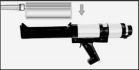
Kartusche in das Auspressgerät legen.                                                                                                     |
