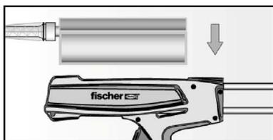
Die Mörtelkartusche in ein geeignetes Auspressgerät legen.
