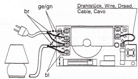
A=Sicherung / A=Fuse / A= Fusible / A=Fusibile / A= Zekering
