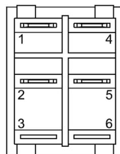
1) Anschlussbelegung, 2-polig, unbeleuchtet, Ein/Ausschalter 1)
