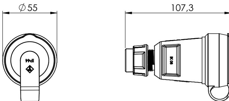
Maßzeichnung – Kupplung mit selbstschließendem Klappdeckel
