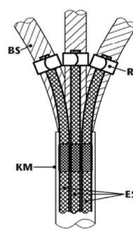
3-Leiter-Kabel mit Kupfer-Bandschirm oder Aluminium-Schirm mit Armierung und eine zusätzliche bestellende Rollfeder (ZR2)
