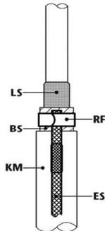
1-Leiter-Kabel mit Kupfer-Bandschirm oder Aluminium-Schirm mit Armierung und eine zusätzliche bestellende Rollfeder (ZR1)
