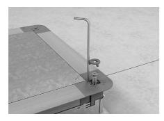
Schraube herausdrehen oder Schraube festhalten, Schnellentriegelungshilfe einstecken und Schraube herausheben.
