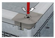
Durch Drehen der Schraube die Dosenhöhe auf ca. 75 mm anheben (Schraubendreher Pozidrive Gr. 2).
