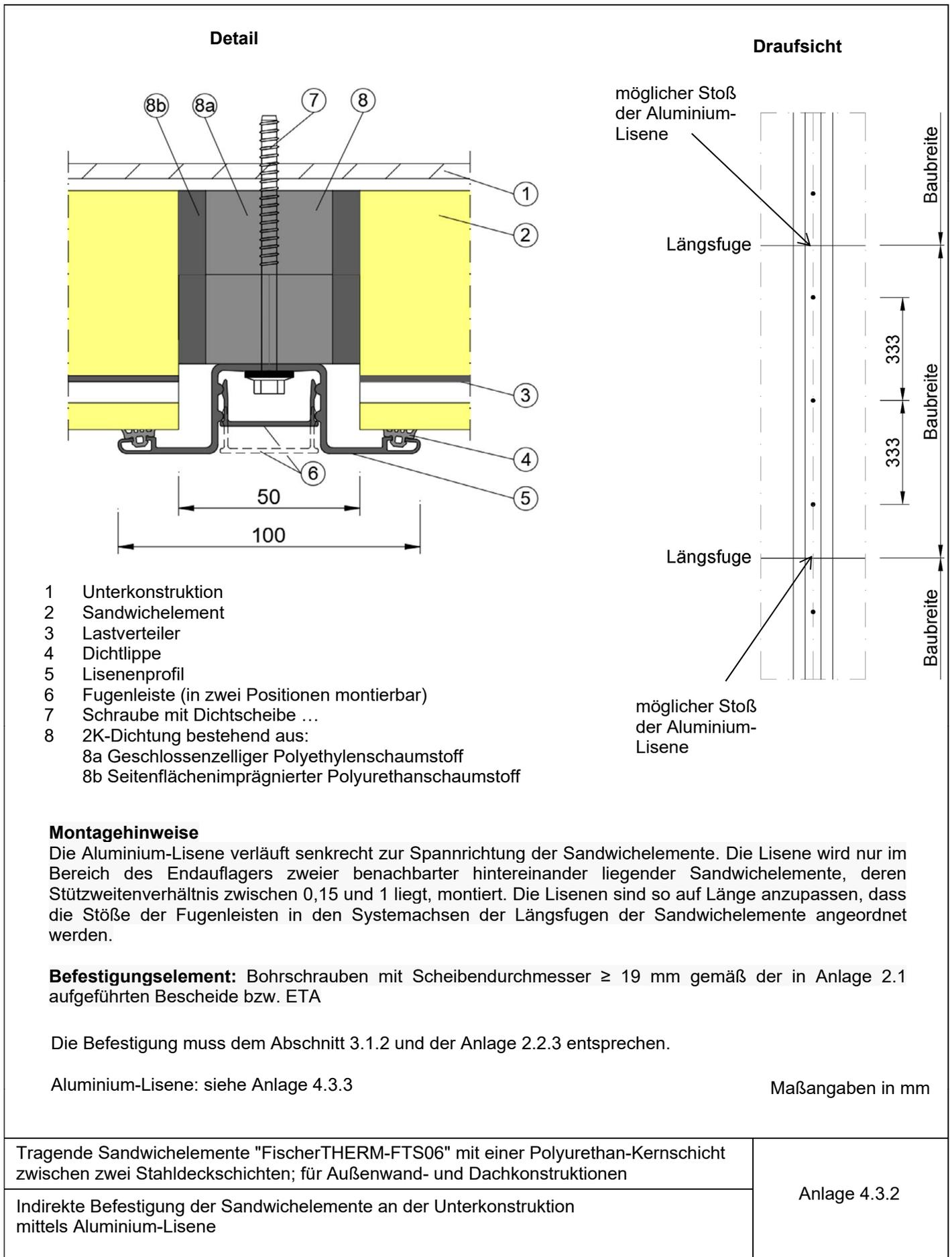
**Darstellung der Aluminium-Lisene mit Fugenleiste und Dichtlippen:**
