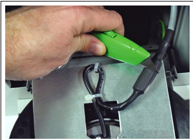
Fig. 27: Schrumpfschlauch, der den Steckverbinder ummantelt, abschneiden
