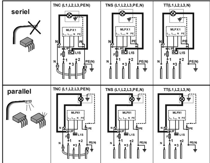
**Mit Überspannungsschutz Typ 2+3**
