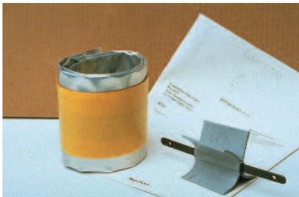
Bei Belegung mit drei oder mehr Kabeln sind Abdichtsterne (RDSS-Clip) in Kombination mit dem Abdichtelement RDSS zu verwenden. Ein RDSS-Clip kann bis zu vier Kabel abdichten. Werden mehr als vier Kabel eingeführt, ist für jeweils drei zusätzliche Kabel ein weiterer Abdichtstern zu verwenden.
