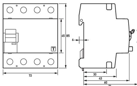
Maßzeichnung Fehlerstromschutzschalter DFS 4 040-4/0,30-PV R
